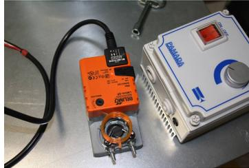
Un des 2 servo est déjà installé, sur la vane de recyclage d'air chaud, et se trouve piloté par un arduino branché sur le serveur frontale de la machine de calcul.
